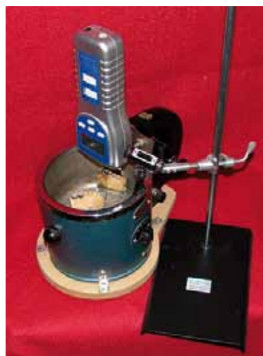
Fig. 2: Modelo dentro de la cuba conectado al dinamómetro y termómetro digital.
