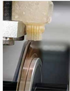
Fig.4 Corte de los bloques de composite.
