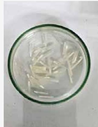
Fig. 5 Barras de 1mmx1mmx10mm conservadas en agua destilada en estufa a 37°..
