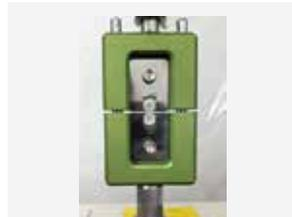
Fig.7 Ensayo de Microtracción en Sistema de Ensayo de Materiales Instron 3369.
