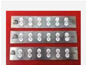
Fig.6 Muestras fijadas con cianoacrilato a los dispositivos para el ensayo.
