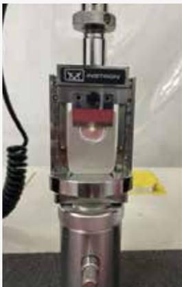
Fig. 2. Muestra en estudio con el método Sheart Test en Instron 3369
